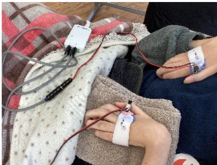
図3 本研究実践で生徒Dがタブレット端末を操作するために使用したオリジナルスイッチ
